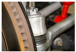
Fig. 14: Tie rod end link.
