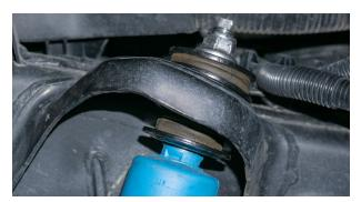
Fig. 17: Remove stem top nut.
