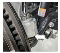
Fig. 1: Tie rod end link.
